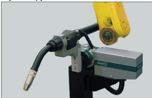
Antorcha en estación de depósito sin acoplar en robot
